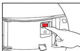
Поставьте переключатель в позицию «ON». Загорится непрерывный оранжевый свет, свидетельствующий о разогревании прибора. Через 15-20 минут свет станет зеленым. Это означает, что ловушка Mosquito Magnet® полностью готова к эксплуатации.
