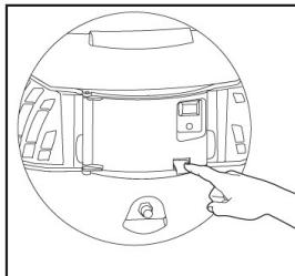
Откройте крышку блока установки элементов питания с тыльной стороны ловушки
