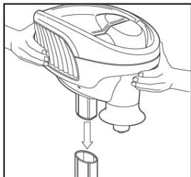
Наденьте основной блок на штатив, нажмите двумя руками для полного закрепления. При правильной сборке передняя часть основного блока «смотрит» в одну сторону с U-образной подножкой
