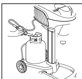
Убедившись, что газовый баллон закрыт, присоедините шланг с редуктором от установки к газовому баллону
