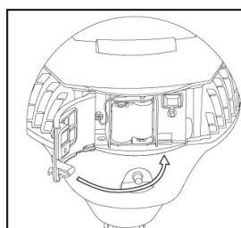
Закройте крышку блока установки элементов питания до характерного щелчка.
