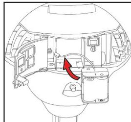
Подсоедините аккумулятор к установке и поместите аккумулятор в блок установки элементов питания.
